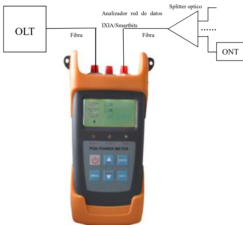
Diagrama de configuración de la prueba de potencia óptica de la interfaz OLT PON
